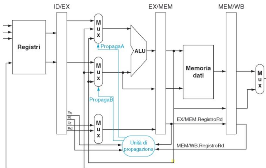
Riassumendo, quindi, l'unità di propagazione attiverà un **forwarding per la fase EXE solo se** quando si ha  $\text{RegWrite} == 1$ ,  $\text{EX/MEM.rd} != 0$  e  $\text{MemRead} == 0$  si verifica che:
