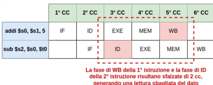
Per risolvere la criticità, dunque, possiamo **allineare le fasi di WB e ID** delle due istruzioni introducendo **due stalli** nella pipeline, ossia un'istruzione fantoccio, detta **NOP (No-Operation)**, che funga da "rallentamento" nel caricamento della pipeline, risolvendo il data hazard.
