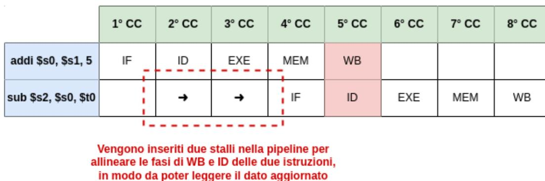
**Chiarimento:** ricordiamo che la scrittura sul Register File viene eseguita nella *prima metà del periodo di clock*, mentre la lettura nella *seconda metà*, dunque è sufficiente sovrapporre le due fasi affinché venga letto il dato corretto, senza la necessità di dover inserire un **terzo stallo**.
